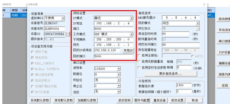
IP 地址为设备 IP, 可通过此处设置端口、网关、掩码和工作模式，目的 IP 或域名为接收装备地址（比如监控计算机）。设置完成后点
