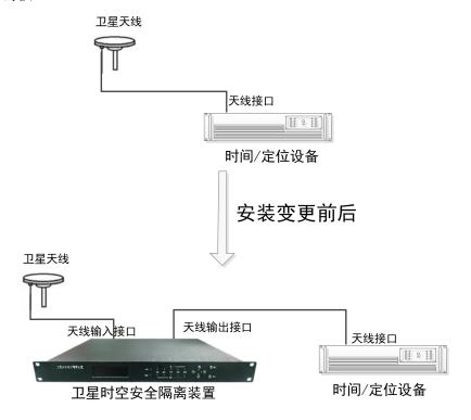
图 4 设备连接图
